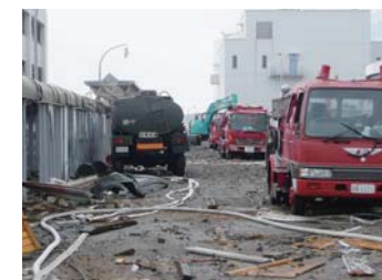
福島第一原子力発電所における消防車による注水の様子(2011年3月16日撮影)
