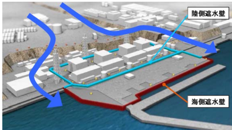
遮水壁設置後の地下水の流れ
