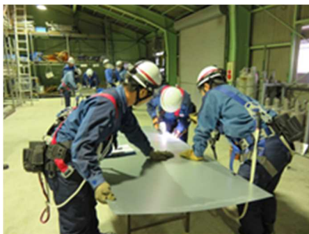
空調設備のダクト修理訓練の実施（柏崎刈羽） （左：材料加工、右：高所でのダクト補修作業）
