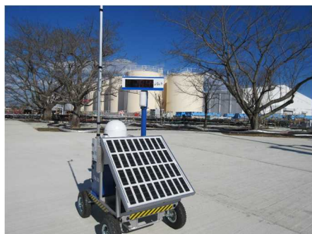
線量率モニタの設置
