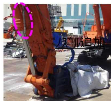
カイゼン後：重機先端に自動散水用ホースを設置
