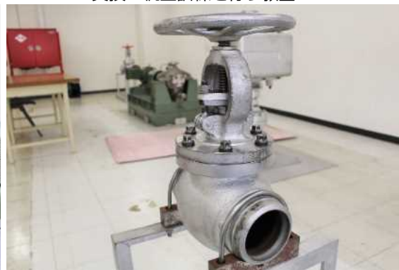
分解点検訓練用の弁（プラント設備と同型式）
